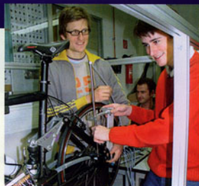
Abb. 1: Messung der Verformungen mit DMS an der CFK-Gabel mit aufgeklebtem Piezofasermes- sensor
