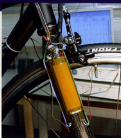
Abb. 1: Messung der Verformungen mit DMS an der CFK-Gabel mit aufgeklebtem Piezofasermes- sensor
